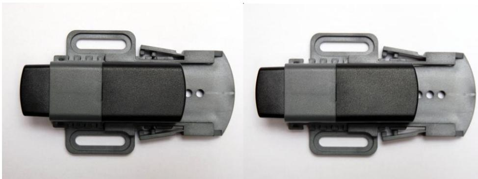
Для контроля положения двери электрических шкафов мы предлагаем концевой выключатель в трех различных версиях исполнения. Например, он может быть использован для включения света при открытии двери (NC) или для включения вентилятора с фильтром при закрытии двери (NO). Вариант с переключающим контактом (CO) может использоваться как с нормально замкнутым и / или нормально разомкнутым контактом.
